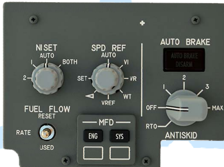
Manual Central Panel MIP B737 IDC.
